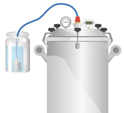
Убедитесь, что при t 95-100°C дышащий клапан закрылся и давление на манометре начало расти
